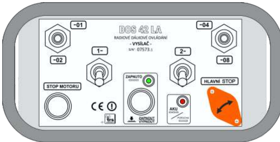
DOS 42 LA standardní/výchozí provedení pro řízení lesní přibližovací lanovky LARIX
