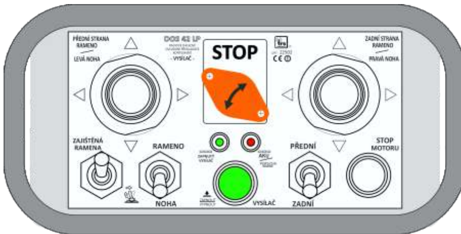
DOS 42 LP - radiové ovládání pracovních pohybů překladače kontejnerů
