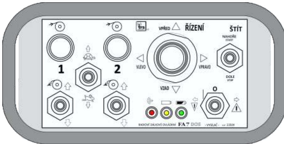
DOS 42 LK - radiové ovládání navijáků a pracovního pojezdu lesního traktoru LAKATOŠ (náhrada původního ovladače FA 7)
