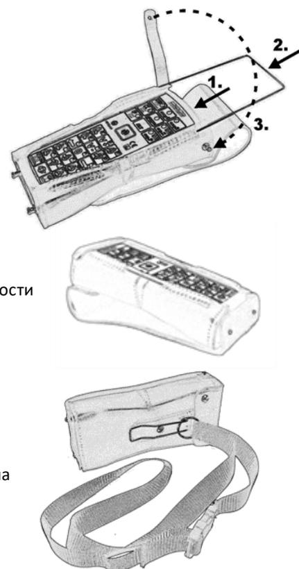
На заводском щитке приводятся воспрещенные манипуляции! Если собственный прибор или его сумка механически повреждены, то пульт управления нельзя применять в взрывоопасной среде!
